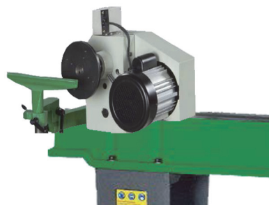
Obr. 15: Podpěra nástroje nalevo od vřeteníku
