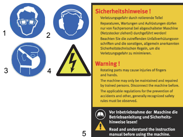
Obr. 1: Výstražné štítky: 1 Použijte ochranné brýle | 2 Použijte ochranná sluchátka | 3 Použijte ochrannou masku Výstražné štítky: 4 Varování před nebezpečným elektrickým napětím | 5 Pokyny
