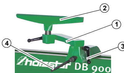
Obr. 14: Nastavení podpěry nástroje
