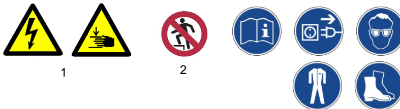
Obr. 1: Výstražné štítky - 1 Nebezpečné elektrické napětí, Nebezpečí poranění rukou | 2 Zákaz vstupu | Přečtěte si návod k obsluze, Vytáhněte zástrčku z elektrické sítě, Použijte ochranné brýle, Použijte pracovní oděv a obuv
