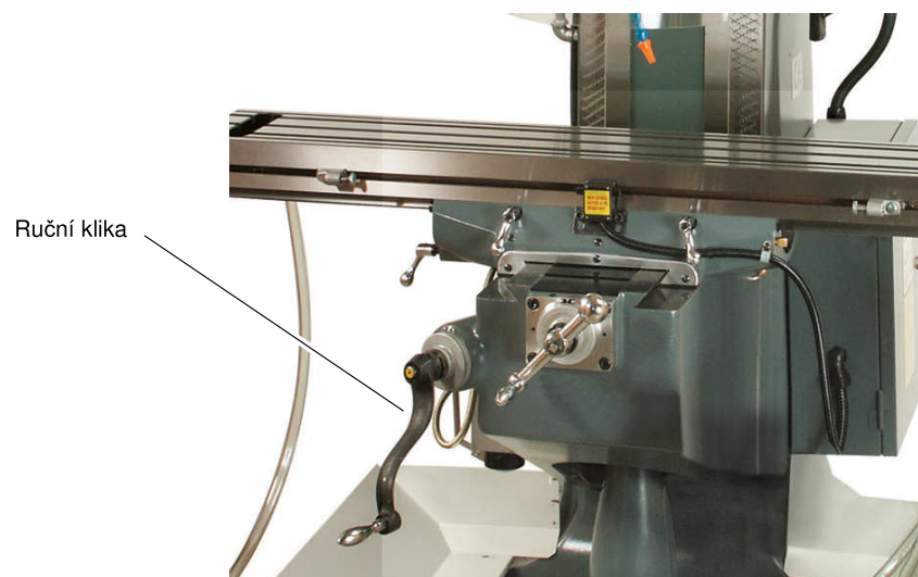
Obr. 0-10: Výškové nastavení křížového stolu
