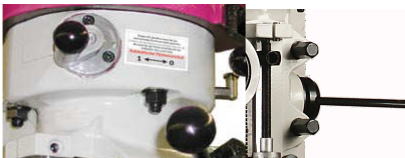
Obr. 0-27: Spínač rychlosti posuvu pinoly
