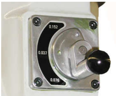
Obr. 0-26: Otočný přepínač - rychlost posuvu pinoly
