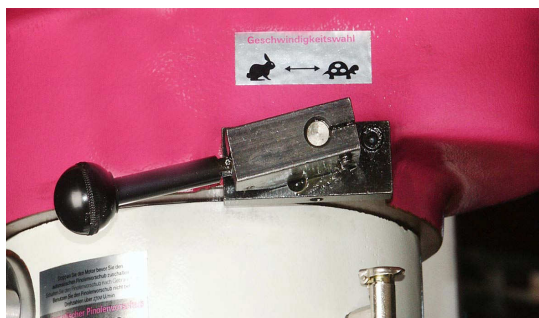
Obr. 0-19: Spínač převodovky v neúplně zařazené neutrální poloze
