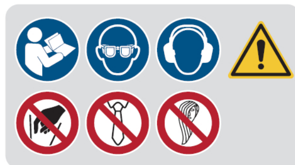
Obr. 1: Výstražné štítky: Přečtěte si návod k obsluze, použijte ochranné brýle, ochranná sluchátka - 2 Bezpečnostní pokyny
