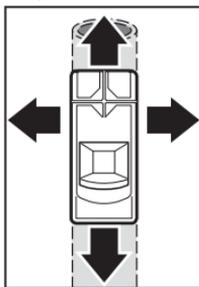
Deplasează în permanență aparatul de măsură în linie dreaptă în lateral, exercitând o presiune ușoară deasupra substratului, fără a ridica aparatul sau a modifica forța de apăsare. Ține aparatul de măsură în mod uniform și ferm de suprafața de prindere **(1)** și nu introdu mâna în zona de detecție a senzorilor **(6)** în timpul măsurării.
