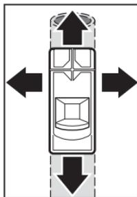
Pohybujte meracím prístrojom vždy priamo v bočnom smere s miernym tlakom po podklade bez toho, aby ste ho zdvíhali alebo menili prítlak. Merací prístroj držte za úchopové plochy (1) rovnomerne pevne a počas merania nesiahajte do oblasti senzora (6).
