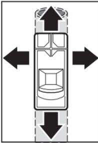
Завжди ведіть вимірювальний інструмент прямолінійно в бік по поверхні з легким натисканням, не піднімаючи і не змінюючи зусилля натискання. Тримайте вимірювальний інструмент рівномірно за поверхню рукоятки **(1)** і не торкайтеся зони датчика **(6)** під час вимірювання.
