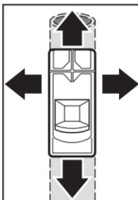
Mjerni alat uvijek pomičite pravocrtno u bočnom smjeru laganim pritiskom po podlozi bez podizanja ili mijenjanja pritiska. Ravnomjerno čvrsto držite mjerni alat za površinu zahvata **(1)** i tijekom mjerenja ne zahvaćajte područje senzora **(6)**.
