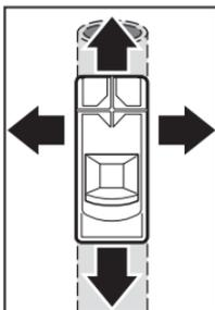
Өлшеу құралын әрдайым көтермей немесе қысу күшін өзгертпей, сәл басу арқылы астыңғы беттің үстінен бүйірлік бағытпен тігінен жылжытыңыз. Өлшеу құралының тұтқа бетінен **(1)** біркелкі ұстап тұрып, өлшеу барысында датчик аймағына **(6)** тиіменіз.
