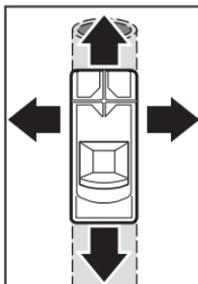
Nedaudz uzspiežot, pārvietojiet mērinstrumentu uz sāniem taisnā līnijā pāri pamatnei tā, lai to nepaceltu un nemainītu piespiešanas spēku. Vienlaicīgi stingri turiet mērinstrumentu aiz satveršanas virsmas **(1)** un mērījuma laikā neiejaucieties sensora darbības zonā **(6)**.
