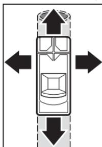
Urządzenie pomiarowe należy przesuwac, wywierając lekki nacisk na podłoże, bez odrywania go od powierzchni ani zmiany siły nacisku – zawsze w linii prostej, w kierunku bocznym. Trzymać urządzenie pomiarowe za powierzchnię chwytową (1) z równomierną siłą i podczas pomiaru nie zasłaniać zakresu działania czujnika (6).
