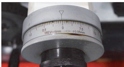
Stupnice na ručním kole příčného suportu
